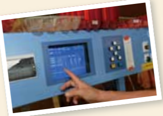
モニターを見れば、洗卵からパック詰めまでの1日の処理量、卵の重量やサイズの分布などのデータが一目でわかる
