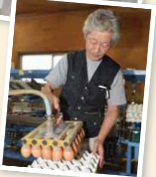
新システムの導入前は、写真のように卵をリフターで吸着しパック詰めしていたが、導入後は大幅な時間短縮が可能になった
