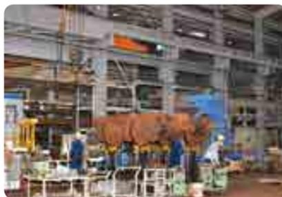
電車の「足」にあたる部分。取りはずして「台車枠」と「車輪」に分け、車輪についているモーターなども分解します。
