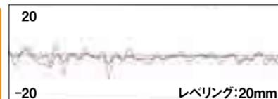
線路は鉄でできているため、夏には伸び、冬に縮むことで、線路が動き、上下のズレが生じることがあります。この上下のズレを修正することを「レベリング作業」と呼びます。
