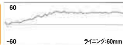
左右方向の線路のズレ・曲がりのこと。列車の運行などによって生じます。この左右のズレを修正することを「ライニング作業」と呼びます。
